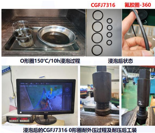
图 5.钻井液浸泡后 O 形圈密封性能验证试验
