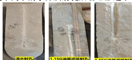
图 4.清水、油基钻井液中射孔实验室实验
