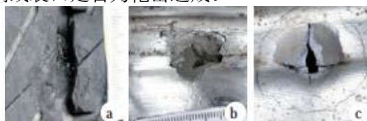
图4.轮胎上疑似枪击形成的弹孔形状(a: 轮胎裂口 b: 钢圈内侧裂口 c: 钢圈外侧裂口)
