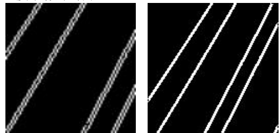
(a) Sobel+自适应抑制处理检测后图像 (b) 经闭运算处理后图像
